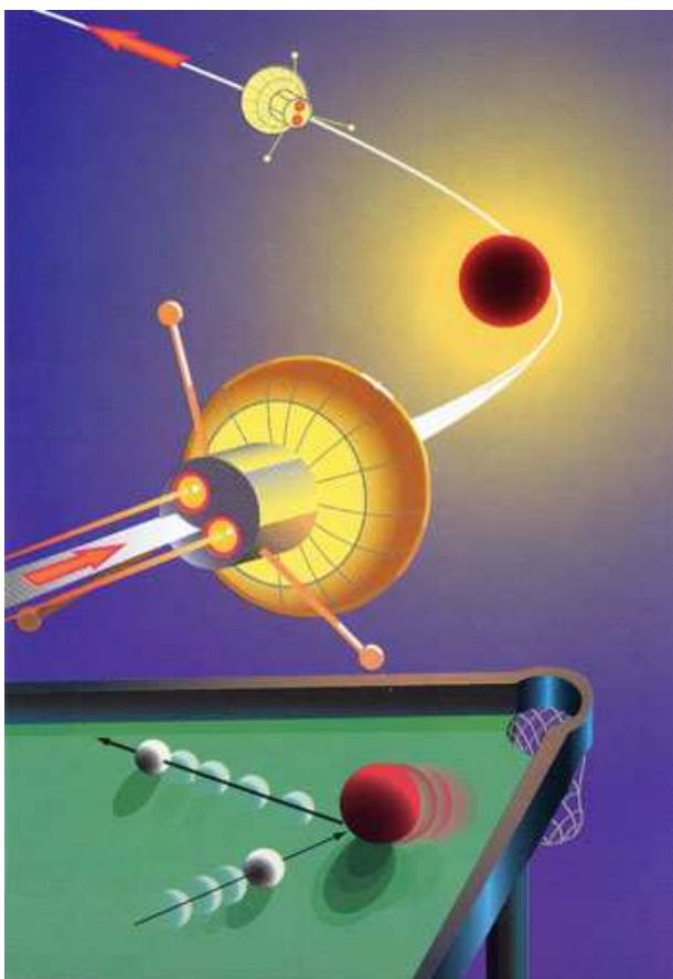
Рис. 4. Гравитационный маневр космического зонда в поле тяготения планеты или звезды в механическом смысле аналогичен соударению двух шаров разной массы: если легкий шар катится навстречу тяжелому, то отскакивает после соударения с возросшей скоростью.
